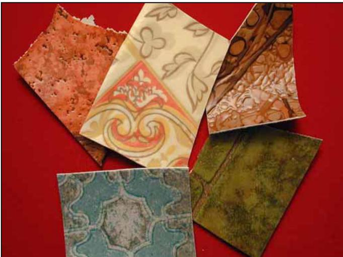
Foto 8: Vinylbodenplatten mit Asbestfasern an der Unterseite (SUVAPRO 2007).
