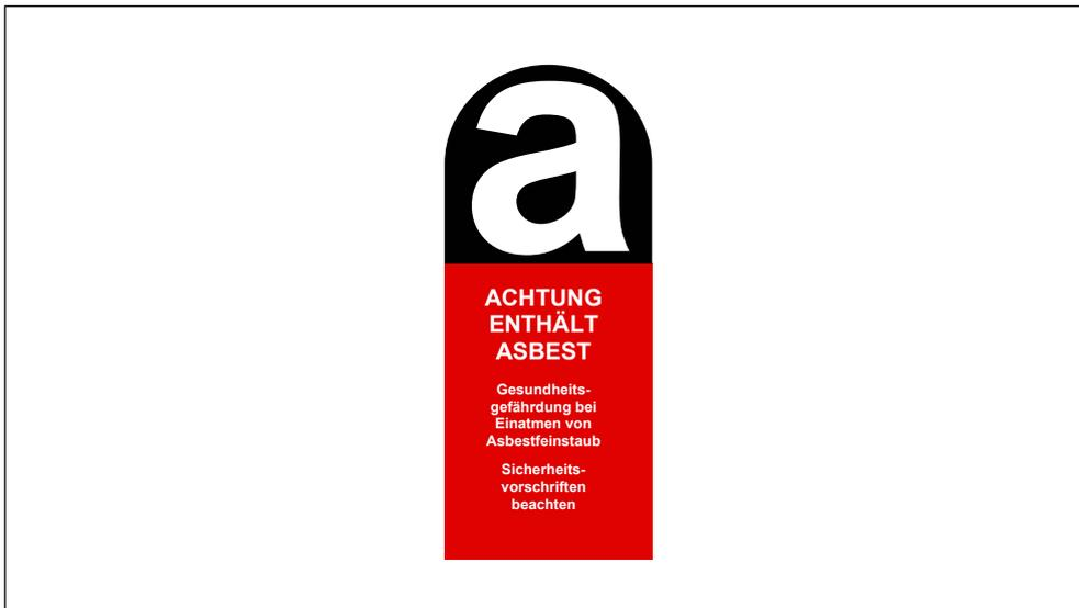
Abbildung 4: Symbol zur verpflichtenden Kennzeichnung asbesthaltiger Güter gemäß Asbestverordnung.
